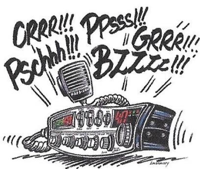
*El botón squelch (o de silencio) se encuentra en todos los emisores-receptores de radio-CB. Esta función permite reducir el ruido de fondo cuando no hay comunicación. Es un ajuste que debe realizarse con precisión y con cierta frecuencia para no mermar las capacidades de recepción de la estación. En resumen, el nivel del ruido de fondo radioeléctrico no es constante y varía en función de la hora y de la zona geográfica.*
