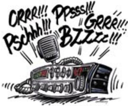
Le squelch (ou silencieux) est une commande que l'on retrouve sur tous les émetteurs-récepteurs radio-CB. Cette fonction permet de réduire le bruit de fond en l'absence de communication. C'est un réglage qui doit être effectué avec précision et renouvelé fréquemment, afin de ne pas diminuer les capacités de réception de la station. En effet, le niveau de bruit de fond radioélectrique n'est pas constant et varie en fonction de l'heure et du lieu géographique.
