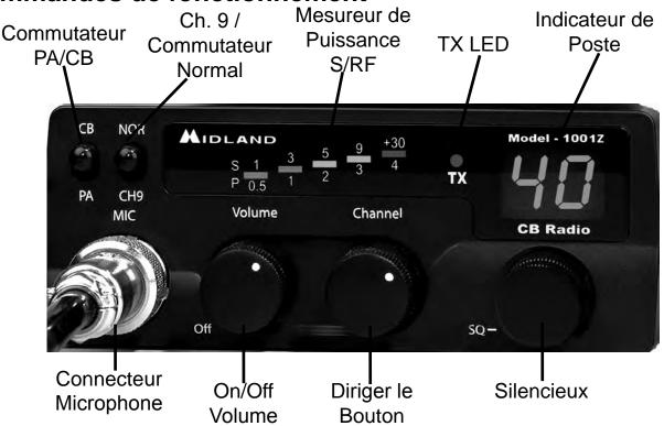
**Connecteur Microphone**: Connectez le microphone fourni à ce connecteur. Les signaux reçus ne seront pas entendus sans le microphone.
