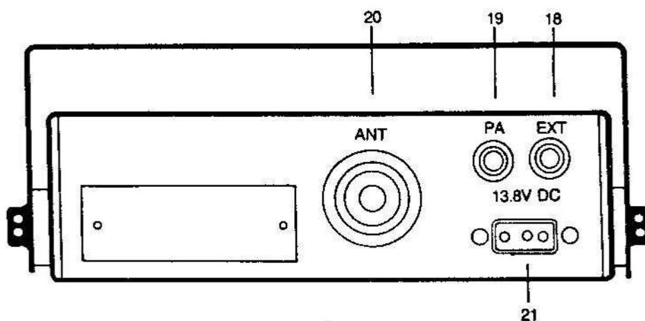
**Fig. 2 Connessioni sul pannello posteriore**
